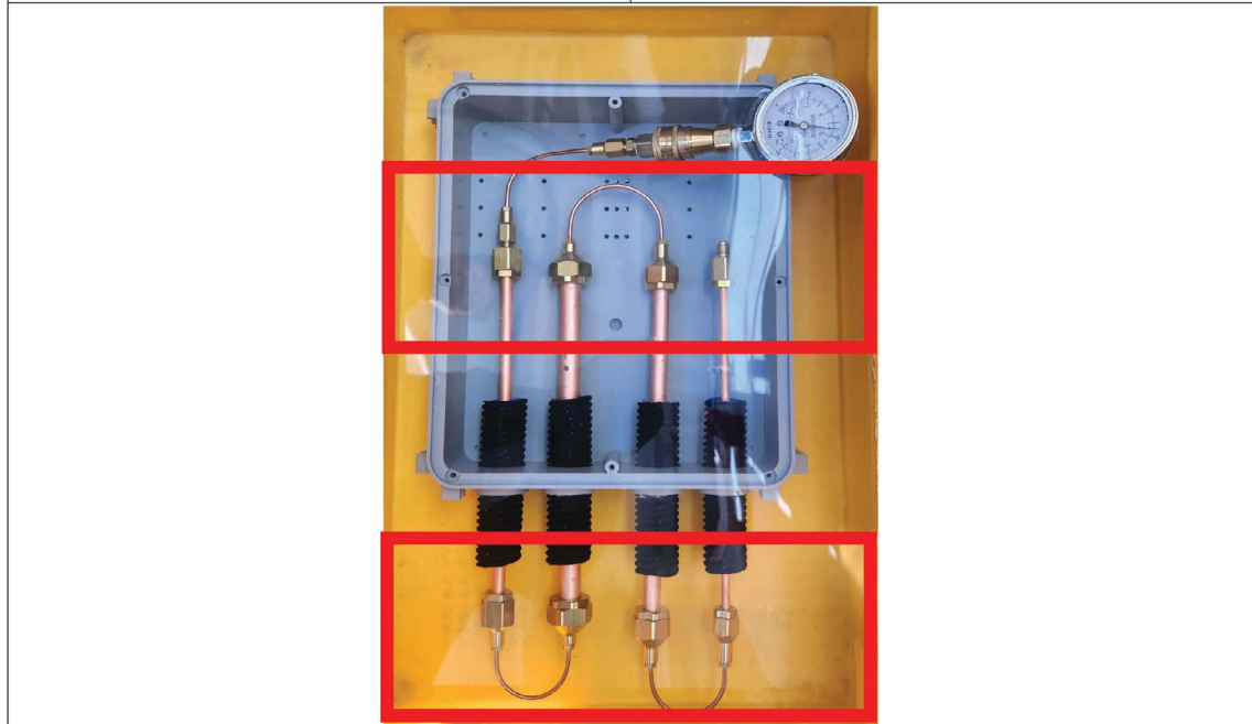
〈 시험 중: 누설 없음, 시험부위: Ø6.35, Ø9.52, Ø12.70, Ø15.88 플레어 관이음식 〉
