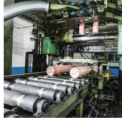
FLYING SAW WITH TILTING BASKET (절단 및 이송 장치)
