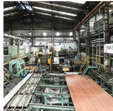
TUBE ROLLING MILL (튜브 레듀서)
